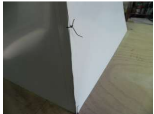
Assemblage des deux pages par reliures (bande adhésive) et liens en tresses de nylon
