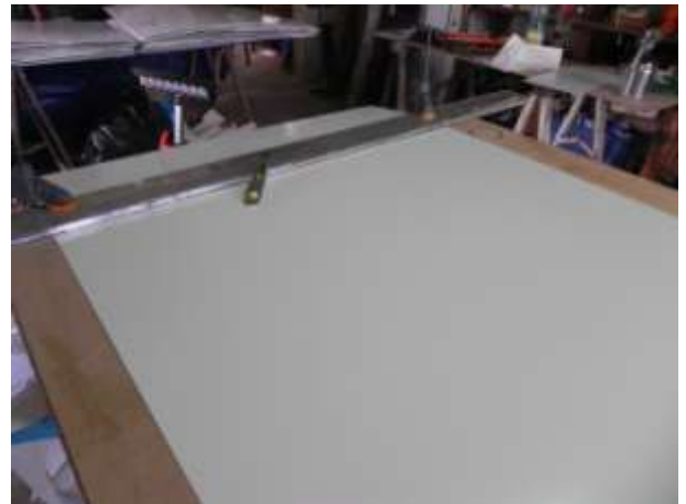
Assemblage des deux pages par reliures (bande adhésive) et liens en tresses de nylon
